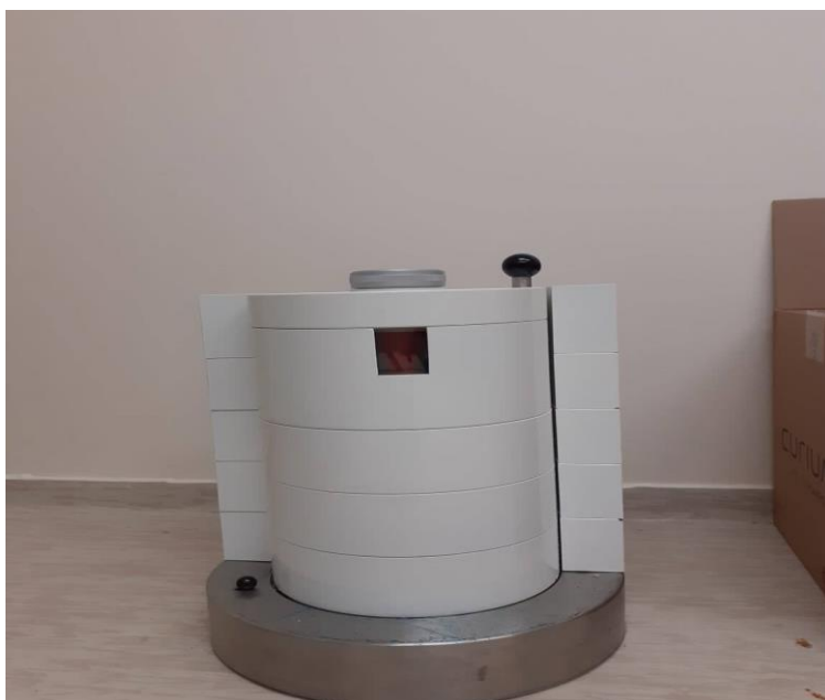
Εικόνα 7. Θωρακισμένη πηγή ενέργειας Tc99.
