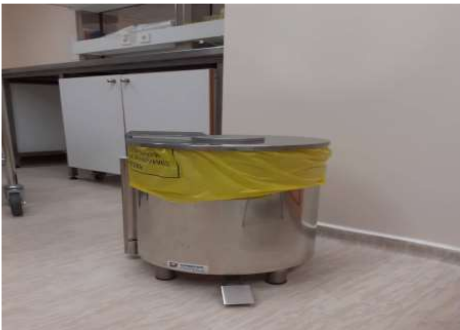
Εικόνα 9. Θωρακισμένος κάδος καταλοίπων.
