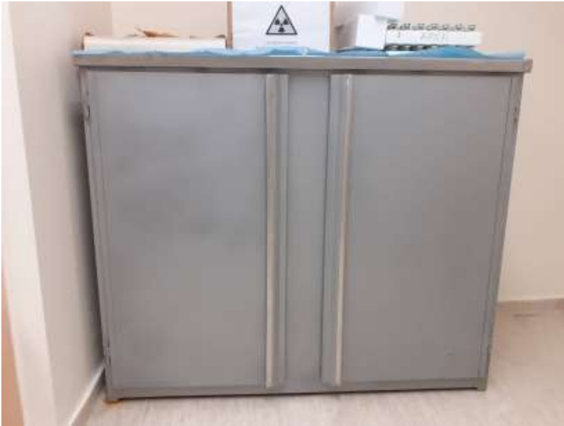
Εικόνα 10. Θωρακισμένη κρύπτη φύλαξης ραδιοϊσοτόπων.
