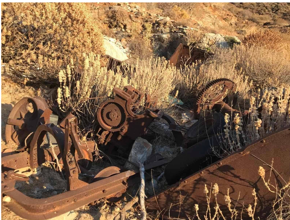
Εικόνα 12. Εγκαταλειμμένα μεταλλικά στοιχεία του μηχανισμού κίνησης των βαγονέτων στη διαδρομή προς την περιοχή της γέφυρας φόρτωσης των μεταλλείων στη Σέριφο.
