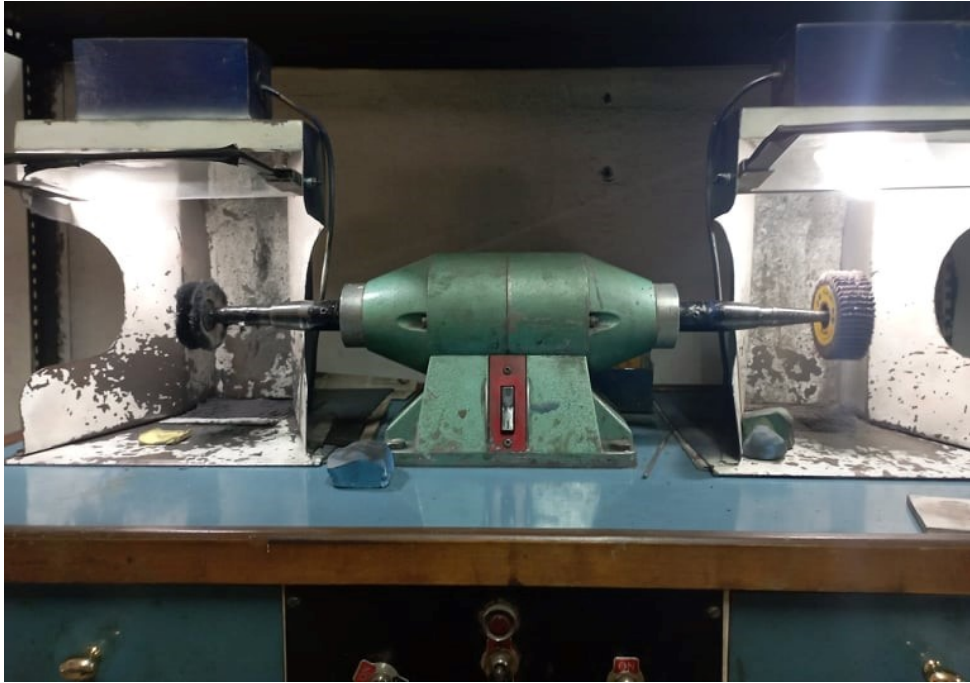
Εικόνα 1. Μηχάνημα στίλβωσης (βούρτσες λουστραρίσματος).
