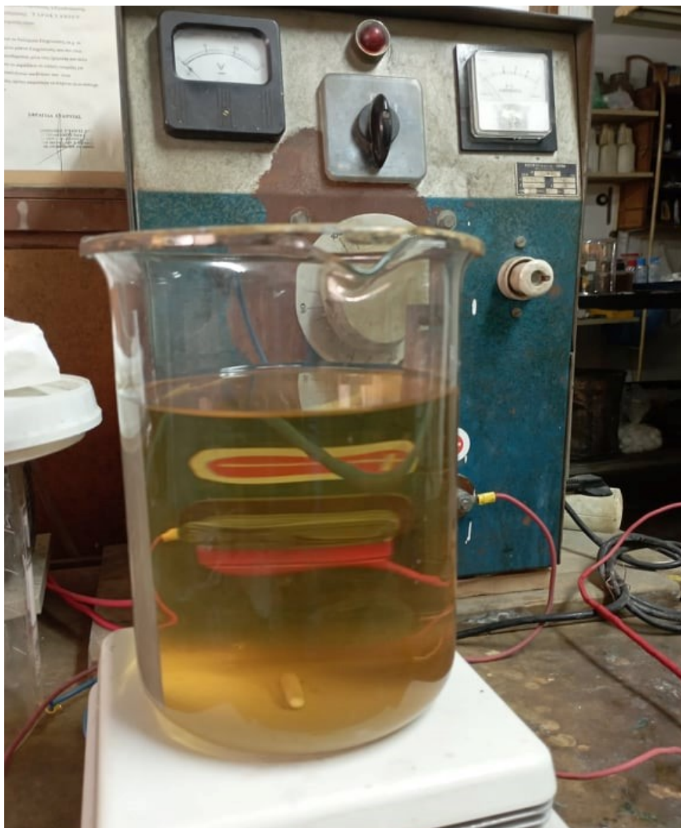
Εικόνα 3. Δοχείο επιχρύσωσης και ανορθωτής τάσης.
