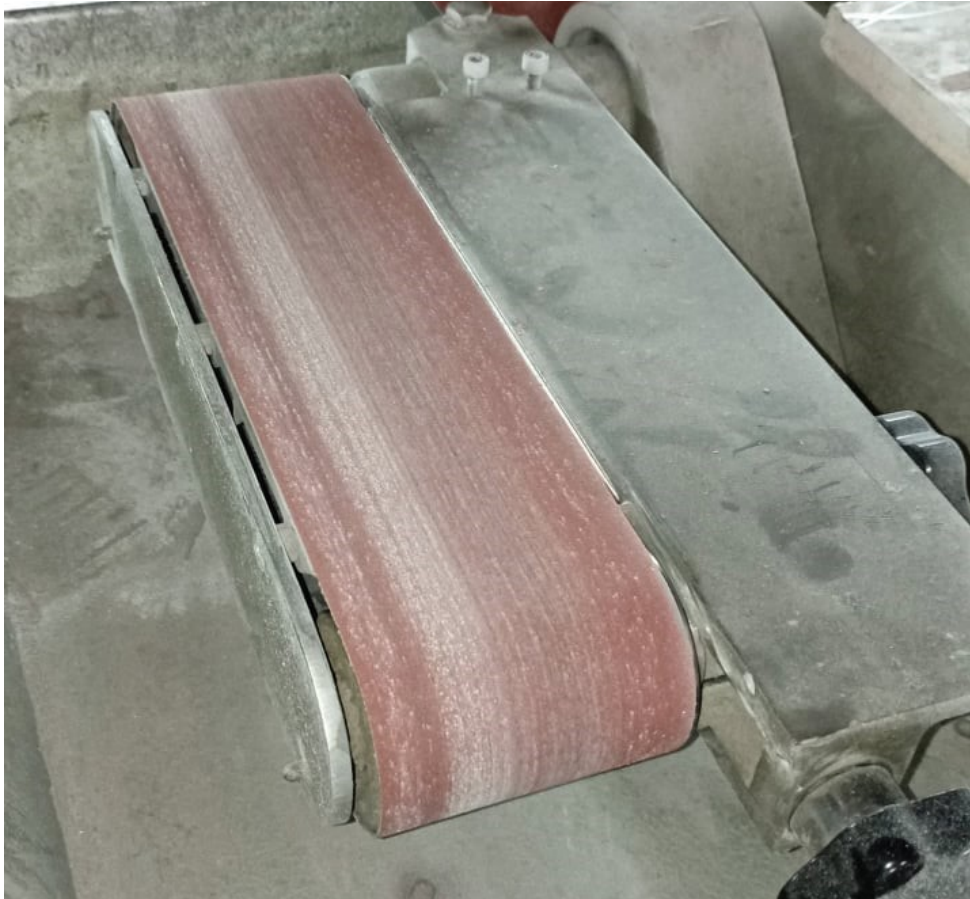
Εικόνα 14. Μηχάνημα με γυαλόχαρτο για φινίρισμα.
