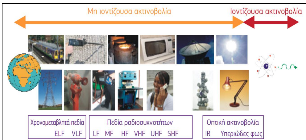
Σχήμα 2. Το Η/Μ φάσμα με τις διάφορες πηγές ΗΜΠ (Πρακτικός Οδηγός).
