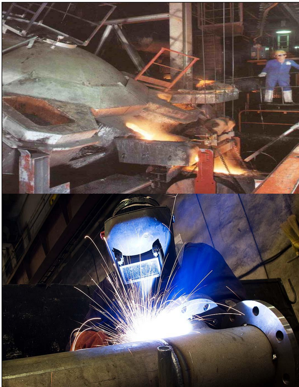
Σχήμα 26. Επαγωγικός φούρνος και ηλεκτροσυγκόλληση.
