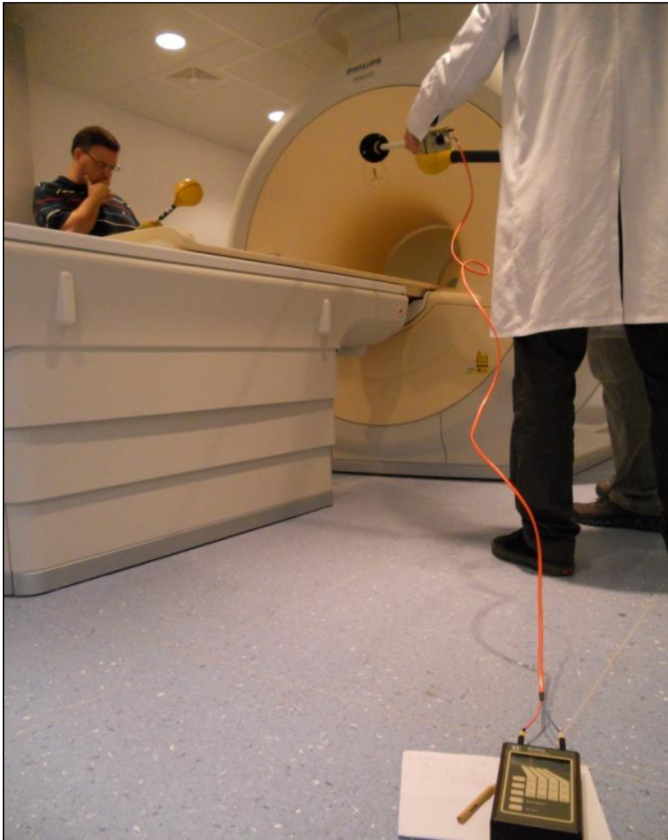
Σχήμα 19. Μετρήσεις ΗΜΠ σε σύστημα MRI.
