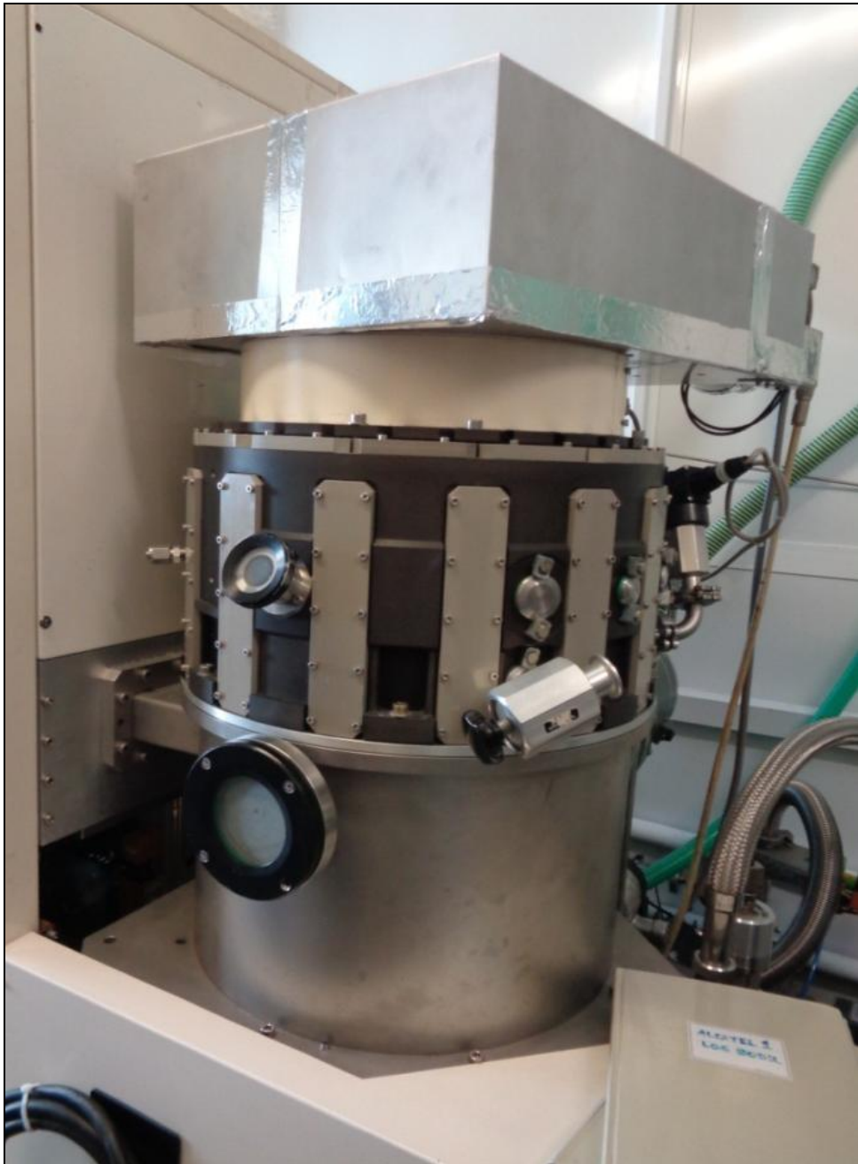
Σχήμα 24. Γεννήτρια RF πλάσματος στο Εργαστήριο Μικροηλεκτρονικής του Εθνικού Κέντρου Έρευνας Φυσικών Επιστημών «Δημόκριτος» - ΕΚΕΦΕ Δημόκριτος.
